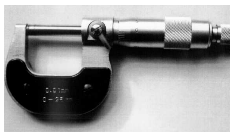
Figura 1: Detalle del nonius
