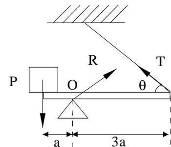
**Datos:**  $T=100 \text{ N}$ ,  $P=10 \text{ N}$ ,  $R=120 \text{ N}$ ,  $a=4 \text{ m}$ ,  $\theta=45^\circ$
