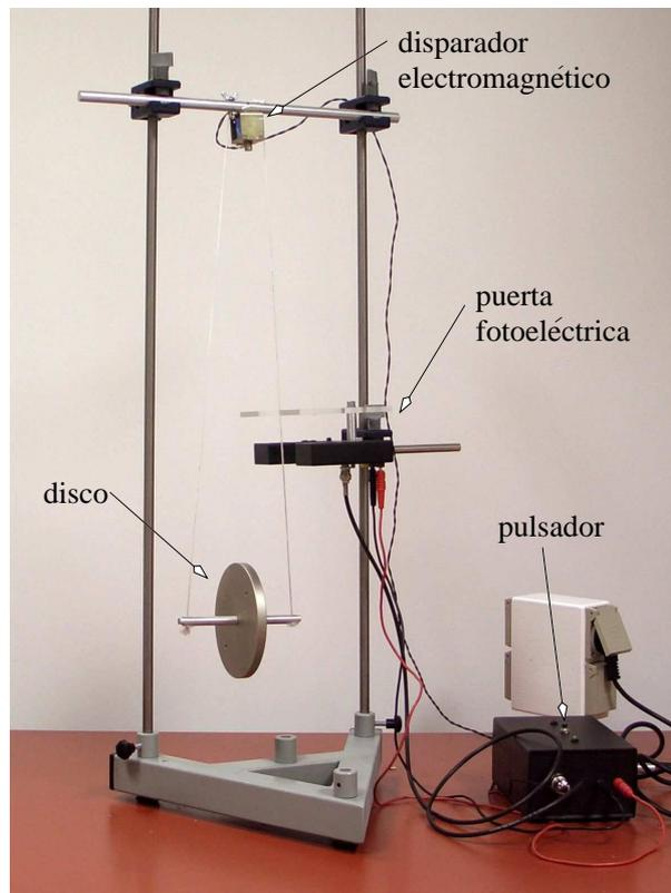
Figura 2: Dispositivo experimental
