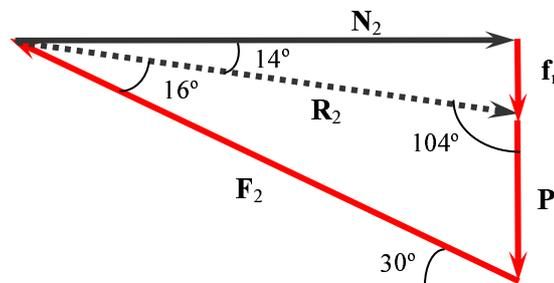
⇒ Aplicando la ley del seno a ambos triángulos queda  $F_1 = 1676 \text{ N} \leq F \leq F_2 = 4224 \text{ N}$
