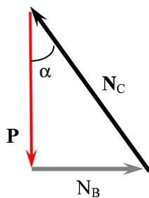
$$\left\{ \begin{array}{l} \frac{N_B}{\sin \alpha} = \frac{P}{\cos \alpha} = \frac{N_C}{1} \\ \text{Sistema de dos ecuaciones} \\ \text{con tres incógnitas} \end{array} \right.$$
