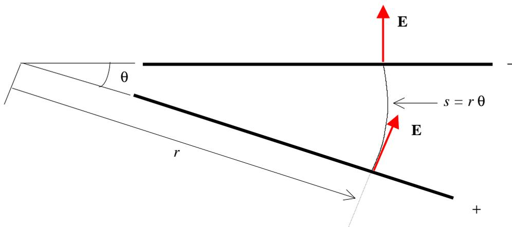
La diferencia de potencial  $V$  es la circulación del campo entre las placas. Luego  $V = E r \theta$ ; pero el campo en un punto de la superficie de un conductor es  $E = \sigma / \epsilon_0$ . Sustituyendo y operando se tiene la densidad superficial de carga a una distancia  $r$  del eje.
