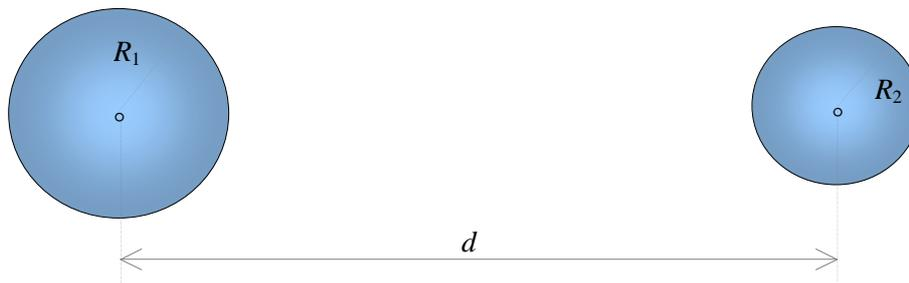
Los coeficientes de capacidad relacionan las cargas con los potenciales mediante las ecuaciones
