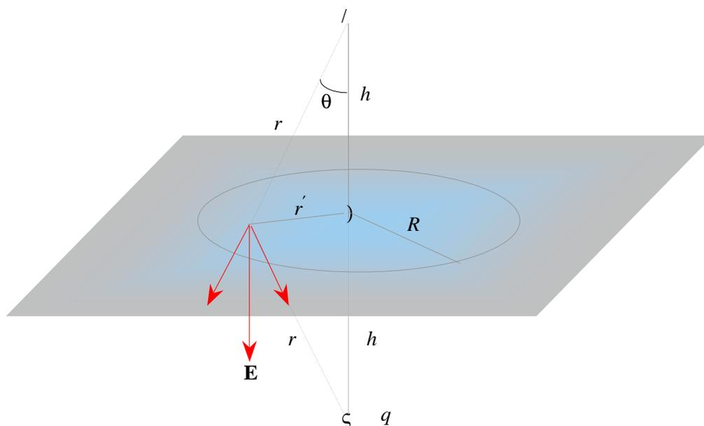
El campo eléctrico en un punto cualquiera del plano es el campo en el mismo punto de la superficie conductora. A una distancia  $r'$  del pie de la perpendicular, el campo resultante  $\mathbf{E}$  es perpendicular a la superficie y dirigido hacia abajo. Tomando el origen de coordenadas en el pie de la perpendicular y los ejes  $x$ - $y$  contenidos en el plano, la expresión del campo es
