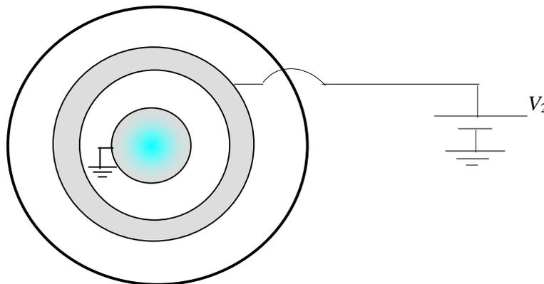
Al conectar a tierra la esfera interior, fluye carga negativa de tierra hacia la esfera hasta que su potencial sea cero y quedará con una carga  $Q'_1$ . La d. de p. Entre el conductor 1 y el 2 es la circulación del campo entre ambos conductores. Operando se tiene
